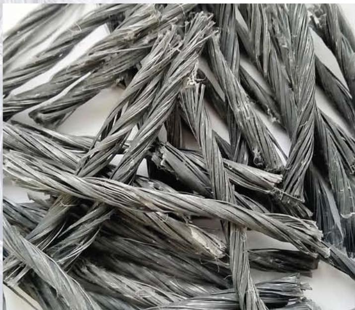
**Фибра X MESH™** — структурное синтетическое макроволокно из ориентированного сополимера полипропилена в виде скрученных жестких волокон, обработанных специальным составом, улучшающим адгезию с бетонным раствором.
